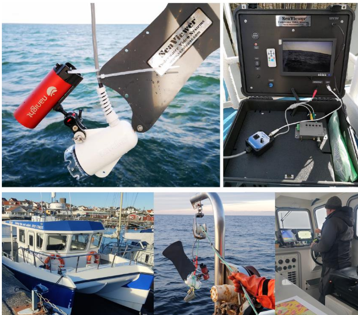
Figur 9. Bilder från fältprovtagningen. Överst till vänster ses dropvideokamera (SeaViewer) inklusive belysning och överst till höger ses konsol med monitor för videoanalys och inspelning. Nedre raden visar katamaranen M/S Blue Lady som användes i fält, kameran förberedd inför filmning samt insidan av hytten och kaptenen. Foton Marine Monitoring AB®.
