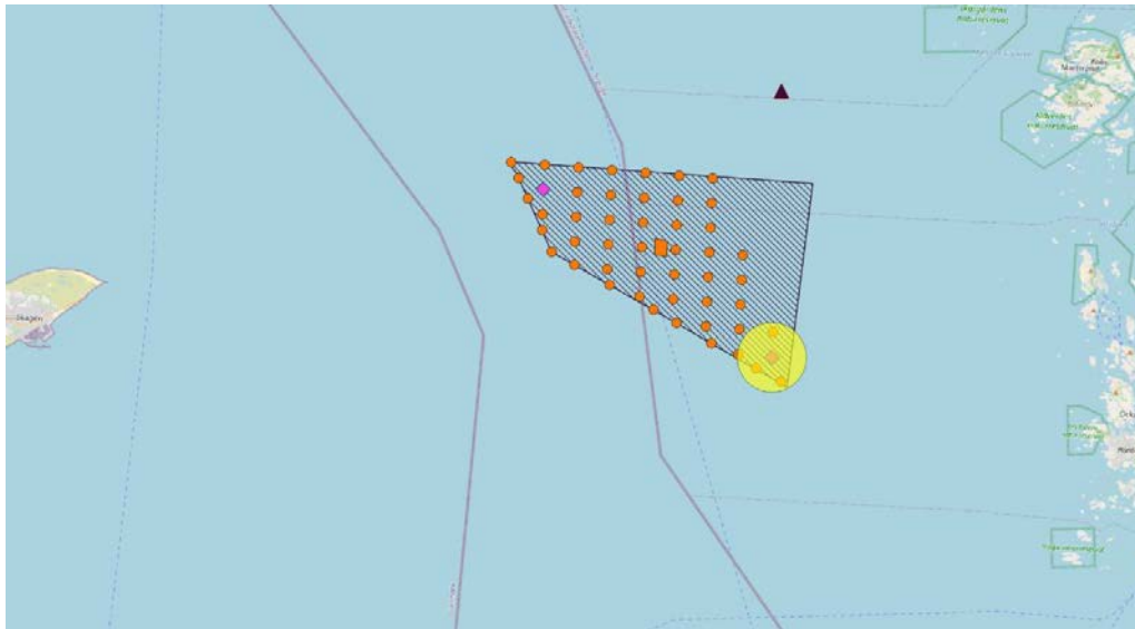
Figur 7-11: Streckad yta visar utredningsområdet för Västvind vindkraftpark. Orange punkter är enskilda vindkraftverk och orange fyrkant är en transformatorplattform. Svart triangel är position för SMHI:s utsjöstation P2. Lila markeringar är positioner för sedimentprovtagningar V_T07 och V_T49 och positionen för provtagningspunkt V_T49 är i mitten av den gula cirkeln. Radien på den gula cirkeln motsvarar beräknad spridningsradie (2 km) för koncentrationer överstigande 100 mg/l intill havsbotten vid borrning på denna plats, vid en strömhastighet på 10 cm/s. Bakgrundskarta © OpenStreetMaps bidragsgivare (openstreetmap.org).
