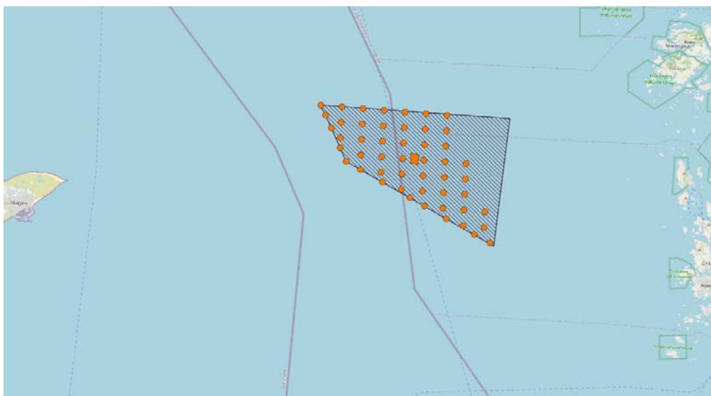
Figur 1-1: Streckad yta visar utredningsområdet för Västvind vindkraftpark. Orange punkter är enskilda vindkraftverk för en exempellayout och orange fyrkant är en transformatorplattform. Jyllands norra udde syns i väster och Marstrand i nordöstra hörnet. Norra delen av Öckerö kommun ligger rakt öster om vindkraftparken.
