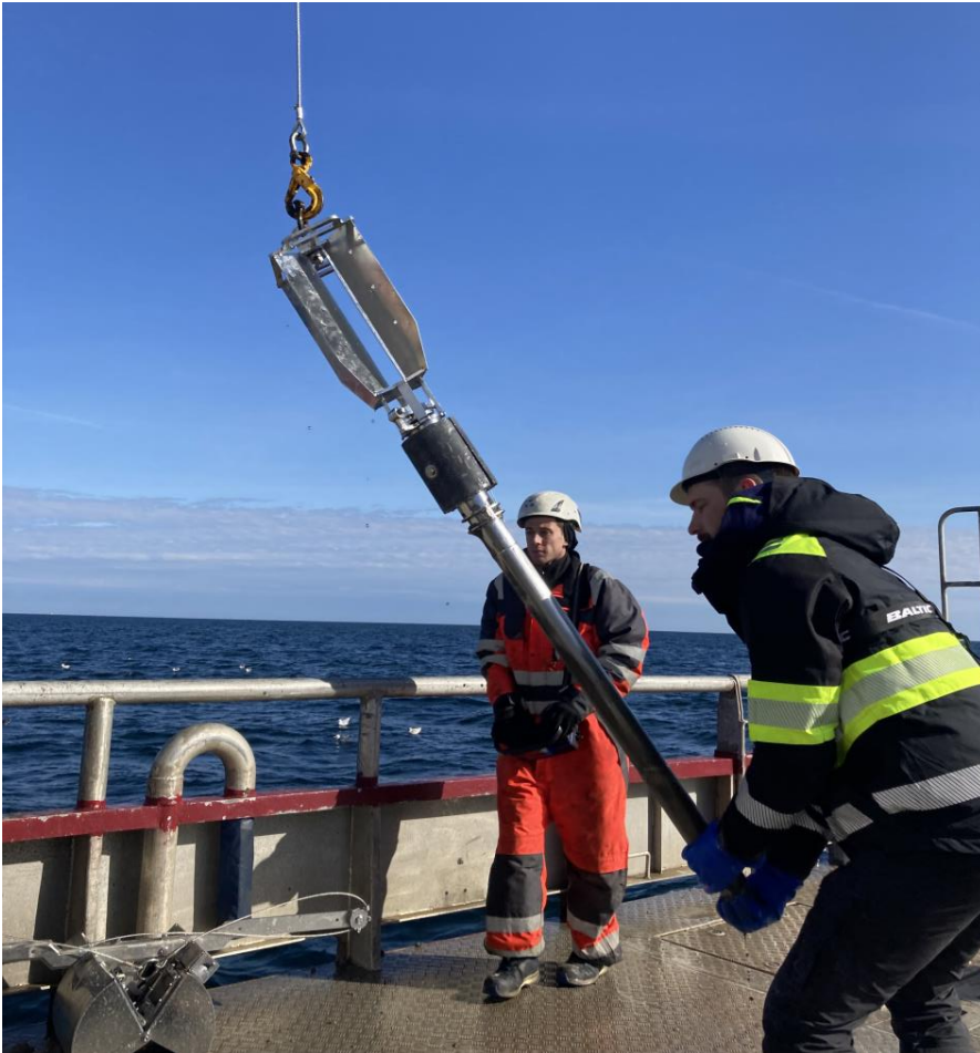
Figur 6.0. Tyngre rörprovtagare görs redo för att sjösättas under fältarbetet i april 2023. Foto: Emilia Benavente
