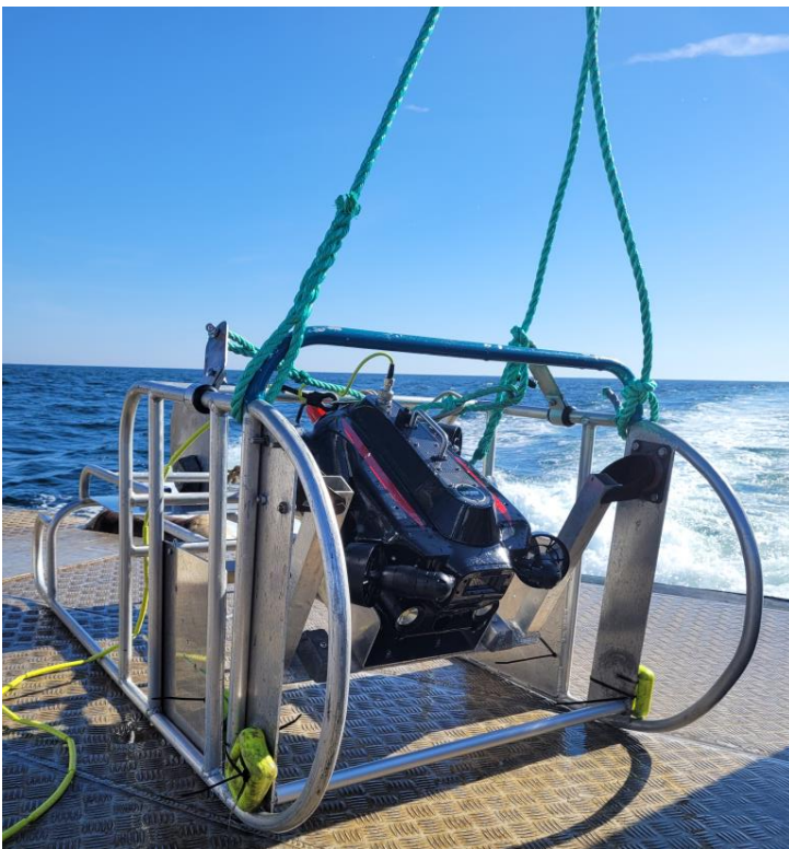
Figur 4.1. Kamerasläden som användes för videundersökningen.
